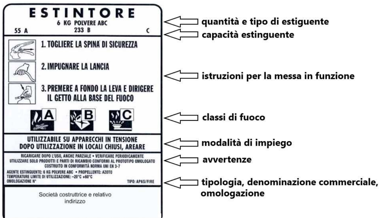
Fac-simile di etichetta di un estintore con indicazione delle informazioni in essa riportate
